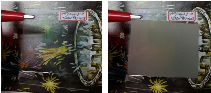
<ZITO/Ag/ZITO 투명전극 적용 PDLC cell의 on/off 상태 이미지>
