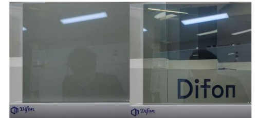
디폰이 개발한 스마트 윈도우 필름을 부착한 윈도우 모습. 분투명한 윈도우(사진 왼쪽)와 투명한 윈도우의 차이가 확인된다.
